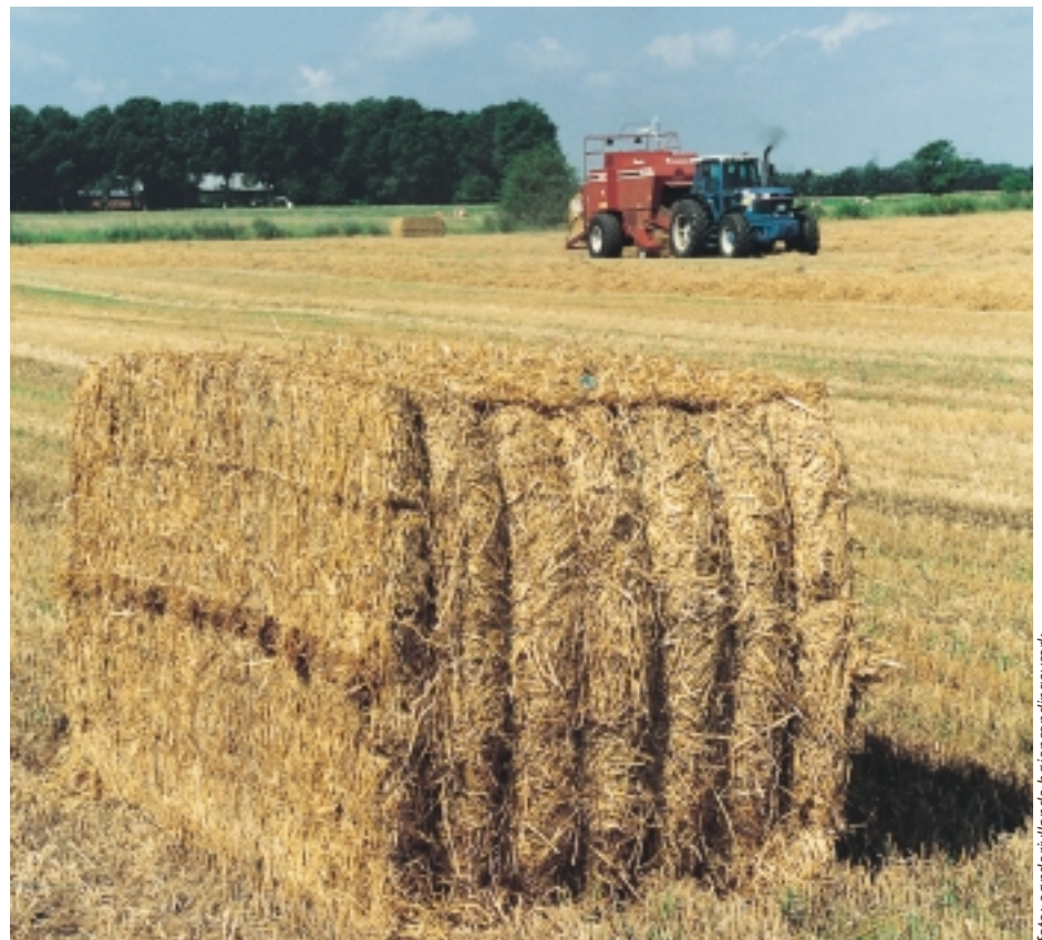
Das Stroh liegt in Reihen auf dem Feld und wird von der Großballenpresse zu Ballen mit einem Gewicht von gut 500 kg gepreßt.
