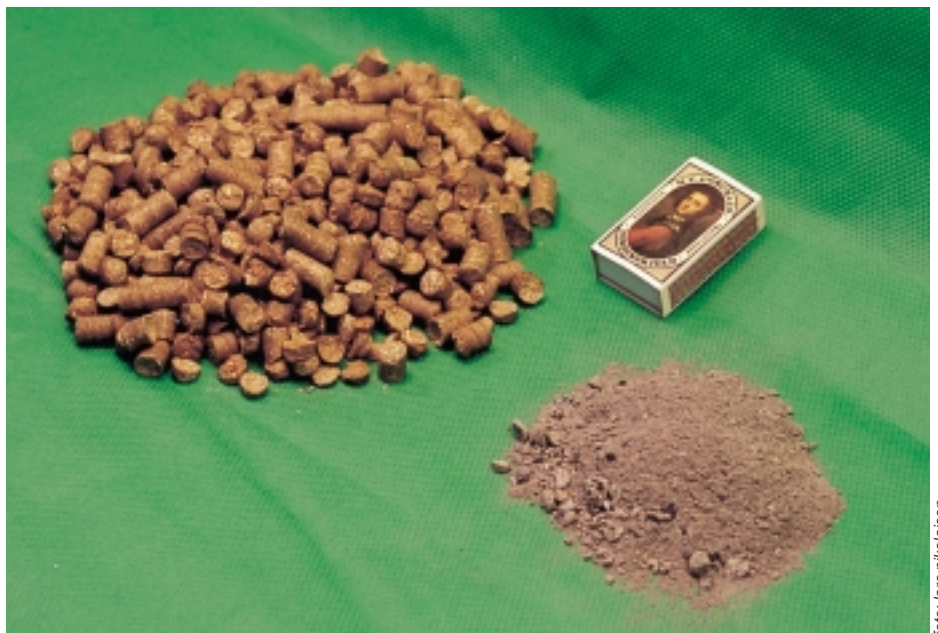
Strohpellets (Durchmesser 10 mm) mit Melasse und Kaolin sowie die zugehörige Aschenmenge von 8-10%. Kaolin verhindert, daß die Asche zu Schlackeklumpen verbrennt, Melasse macht die Pellets transportstabil.
