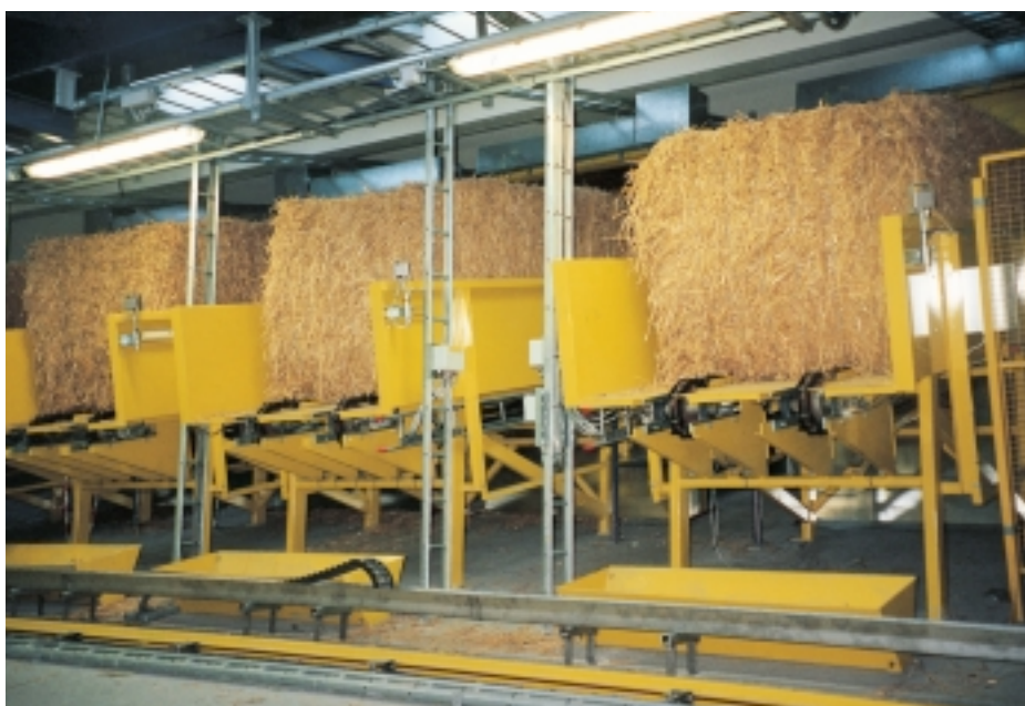
3 af 4 halmlinier på Enstedværket. Storballerne hentes via et transportbånd på halmlageret og fordeles til de 4 linier via en tværgående vogn.
