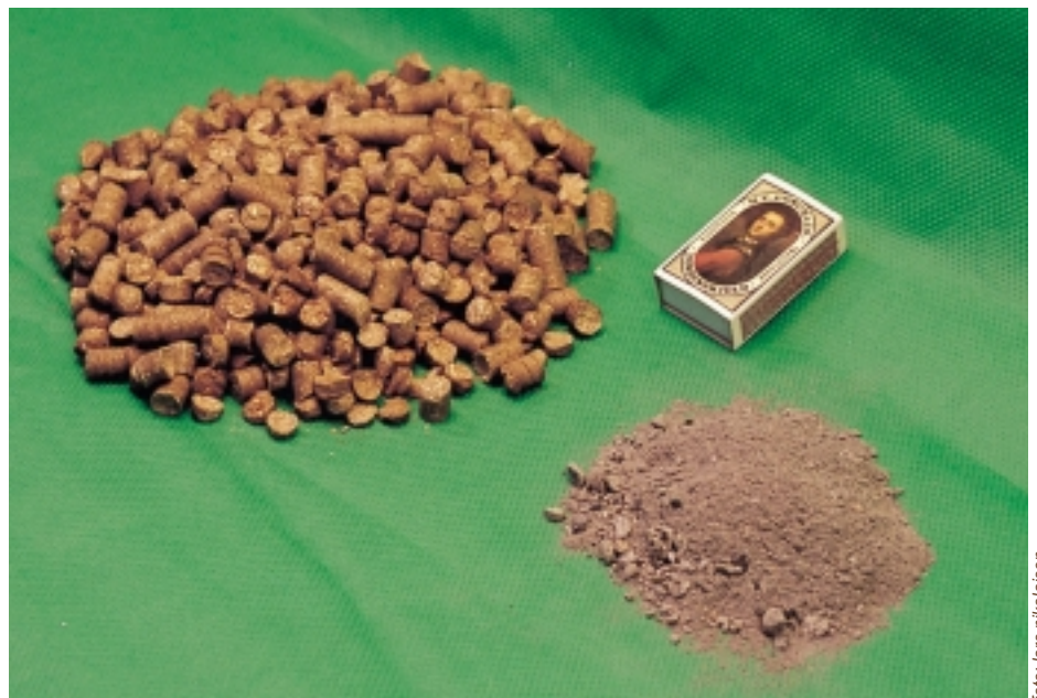
Halmpiller med en diameter på 10 mm iblandet melasse og kaolin, samt det tilhørende askeindhold på 8-10%. Kaolin forhindrer at asken brænder sammen til slaggeklumper. Melasse gør pillerne transportstabile.
