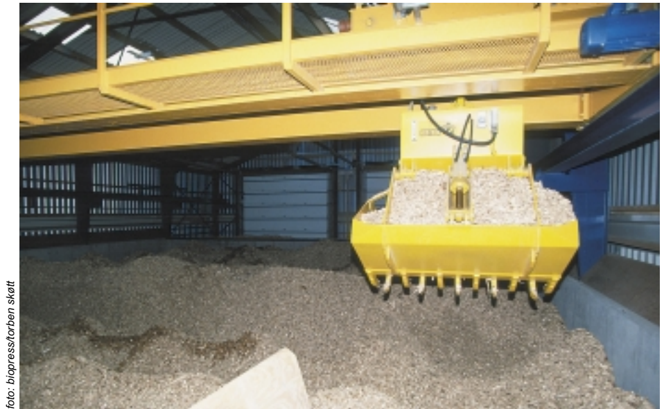
Hackschnitzeldepot mit Kran zum Beschicken der Hackschnitzel-Verbrennungsanlage in Harboøre. Der Kran kann von einem abgeschirmten Kontrollraum aus automatisch gesteuert und überwacht werden.
