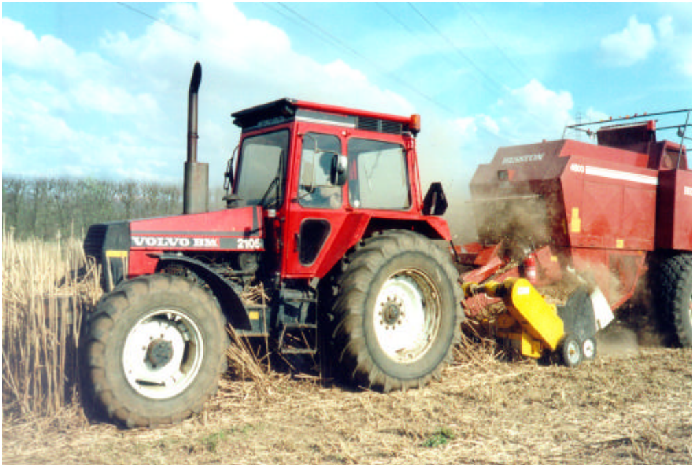
Fig. 8. Storballepresser monteret med snittet foran pickup for direkte høst og snitning af elefantgræs.
